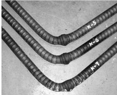
写真2 異径継手の曲げ試験 (D32+D35, SD490)
