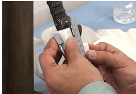
写真8 溶接継手部の超音波探傷状況 (斜めK走査)
