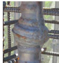
偏心+圧接面のずれ
